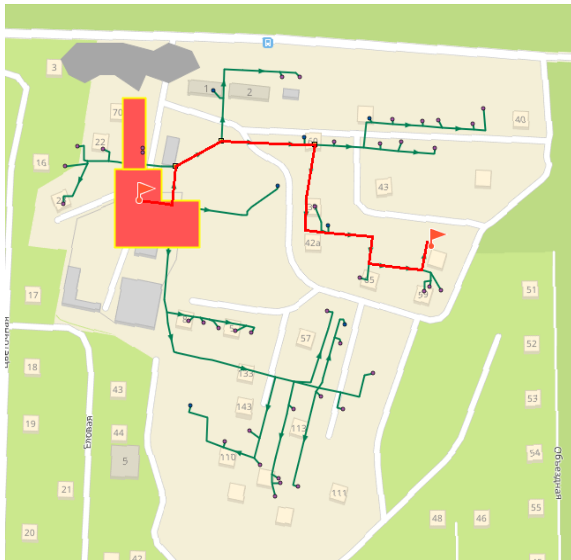
Рисунок 4.35 – Путь движения теплоносителя от источника тепловой энергии до конечного потребителя, в зоне действия котельной №25 п. Лесной (рисунок П46.1 МУ)
