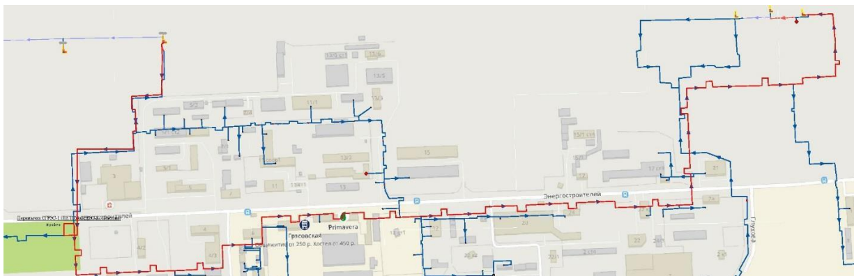
Рисунок 8.23 – Путь теплоносителя при аварии теплопровода СГРЭС-2 – Промзона по перспективной перемычке
