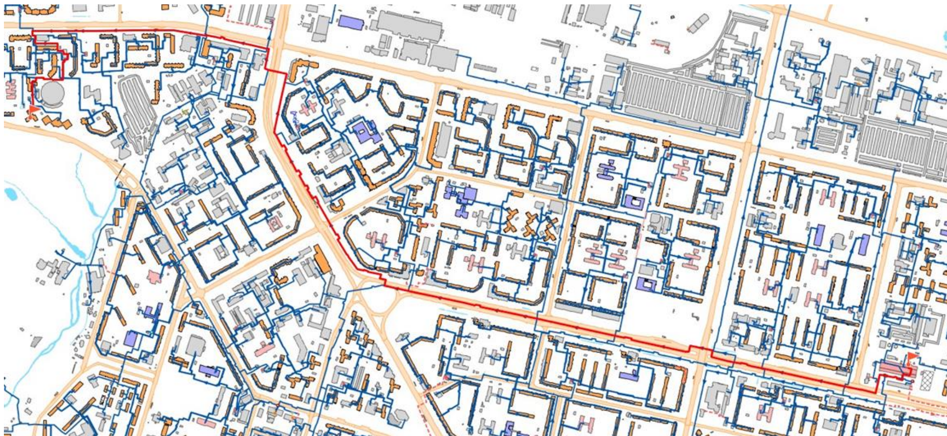
Рисунок 8.39 – Путь построения пьезометрического графика от ПКТС до потребителя с наихудшими параметрами гидравлического режима (отопление и ГВС – уровень аварийной брони, вентиляция – полное отключение)
