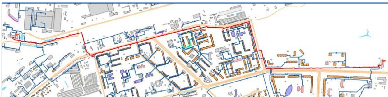
Рисунок 8.46 – Резервная схема теплоснабжения зоны К-45 через переключку 2Ду250
