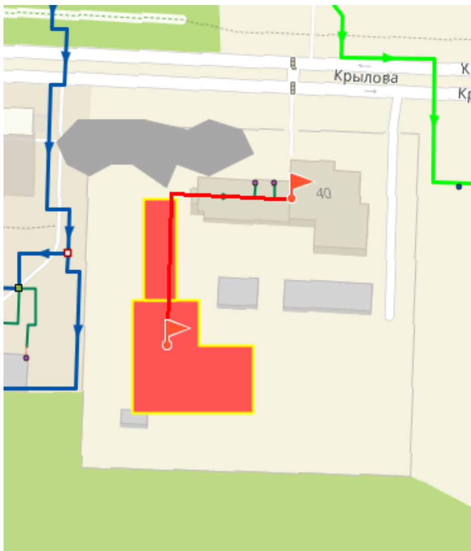
Рисунок 4.51 – Путь движения теплоносителя от источника тепловой энергии до конечного потребителя, в зоне действия котельной №34 Крылова, 40 (рисунок П46.1 МУ)
