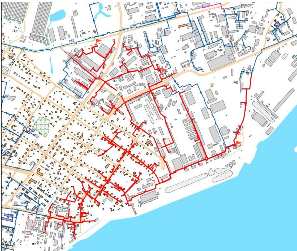
Рисунок 8.12 – Зона ЦТП 88, 90, 100 –наиболее проблемная зона обеспечения тепловой энергией в аварийном режиме
