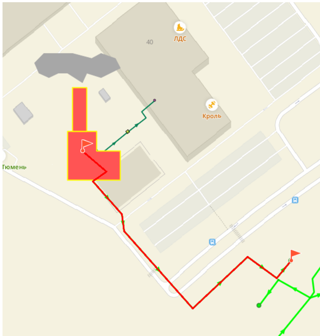
Рисунок 4.31 – Путь движения теплоносителя от источника тепловой энергии до конечного потребителя, в зоне действия котельной №23 "Ледовый Дворец" (рисунок П46.1 МУ)
